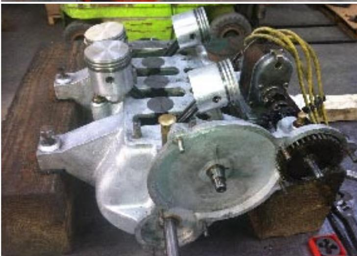
J'en profite simultanément pour refaire la magnéto et recharger puis rectifier le palier du volant moteur chez TSM.
