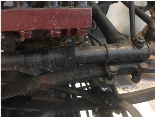
*Pièces de renforcement du châssis*
